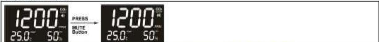
Mute-Taste zum Aktivieren des Alarmtons drücken. Bei aktivierten Alarmton ertönt bei Erreichen von 1200 ppm der Buzzer.
