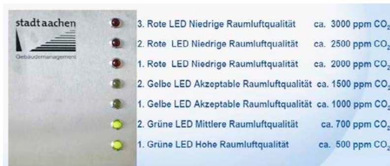
CO 2 -Ampel der Stadt Aachen, die den aktuellen Luftzustand in ihren Bildungseinrichtungen visualisiert (Abb. AMEV)
